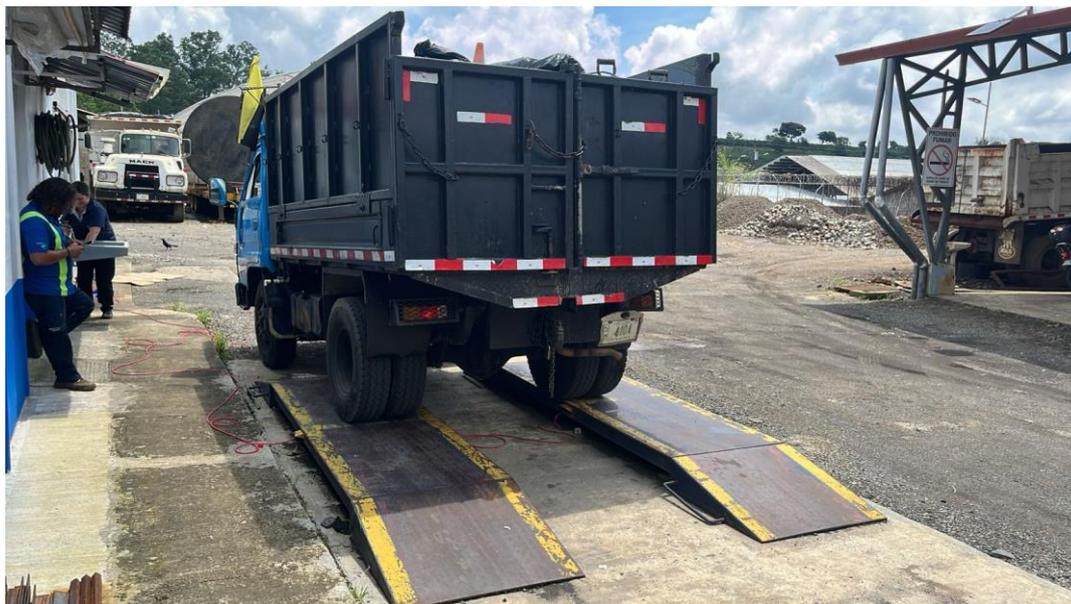
**Figura 3:** Pesaje de vagoneta con residuos en balanza camionera.
